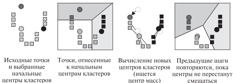
Рис. 3. Пример работы алгоритма k -средних для двумерного случая
