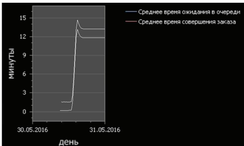
Рис. 12. Зависимость среднего времени ожидания в очереди и времени обслуживания на терминалах от времени суток при четырех работающих терминалах
